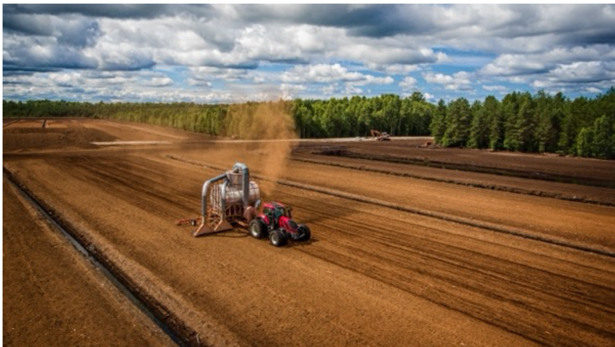
Foto 6.3 Turba pneumaatiline kogumine vanemat tüüpi vaakumkoguriga (Foto: Peeter Koll, OÜ Inseneribüroo STEIGER)
