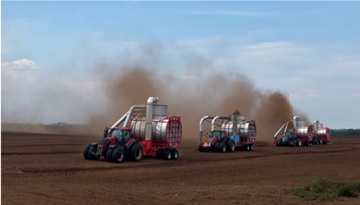
Foto 6.14 Turba kogumine vanemat tüüp vaakumkogujatega, mis ei ole varustatud tsüklonitega (Foto: Erki Niitlaan, MTÜ Eesti Turbaliit)
