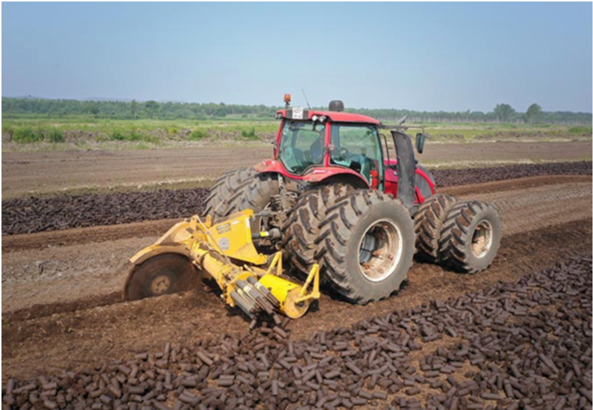
Foto 6.12 Tükkturba lõikamine ja pressimine (Foto: MeriPeat, 2024)
