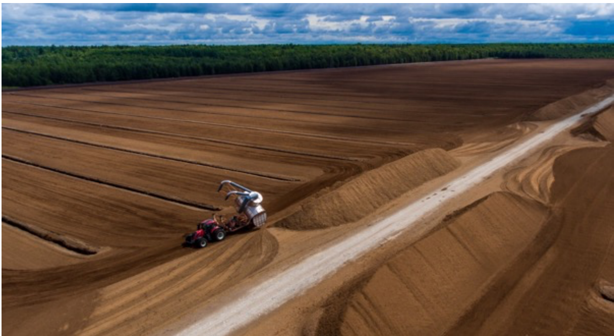
Foto 6.8 Vaakumkoguja tühjendamine auna (Foto: Peeter Koll, OÜ Inseneribüroo STEIGER)
