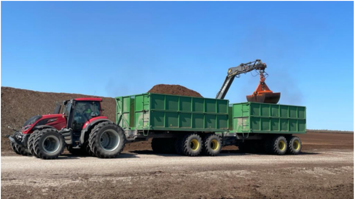
Foto 6.10 Vedu käruga. Laadimine aunast kopp-ekskaatoriga. (Foto: Rakvere Põllumajandustehnika)
