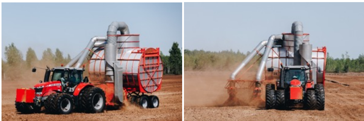
Foto 6.15 Turba kogumine uuemat tüüpi vaakumkogujaga (valmistatud Eestis), mis on varustatud tsükloniga ning kus õhu väljalasketoru on toodud alla paremale küljele (Foto: Andrea Rotenberg, OÜ Elva E.P.T.)
