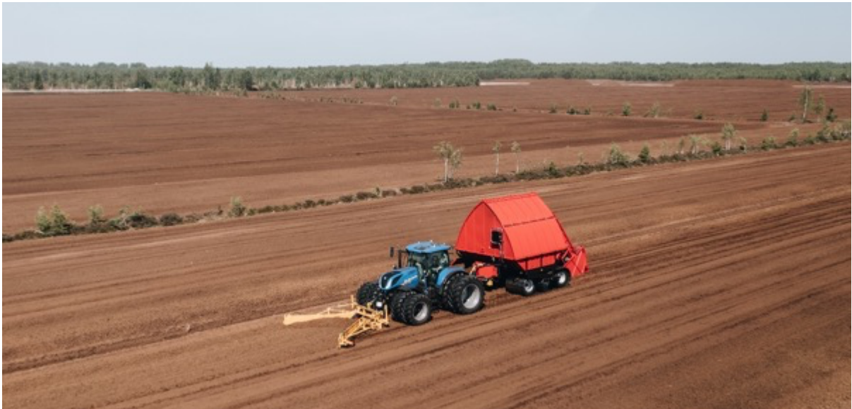
Foto 6.5 Vallitatud turba mehaaniline kogumine (Foto: Andero Kaju, OÜ Elva E.P.T.)
