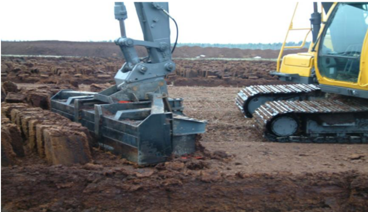
Foto 6.11 Plokkturba lõikamine. (Foto: Ramsi Turvas , 2024)
