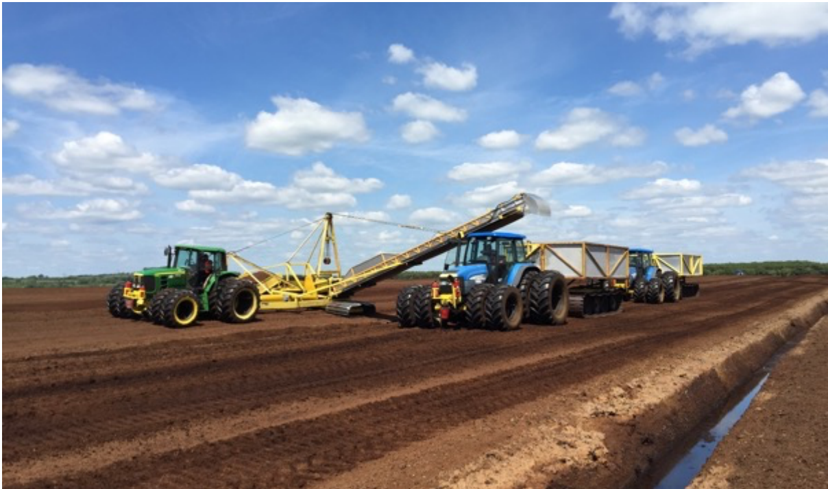
Foto 6.7 Keskse vaalu laadimine lintlaaduriga kärusse. Iirimaa (Foto: Erki Niitlaan, MTÜ Eesti Turbaliit)
